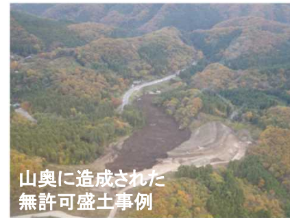
斜面地の谷を埋め、土砂が崩壊した事例
