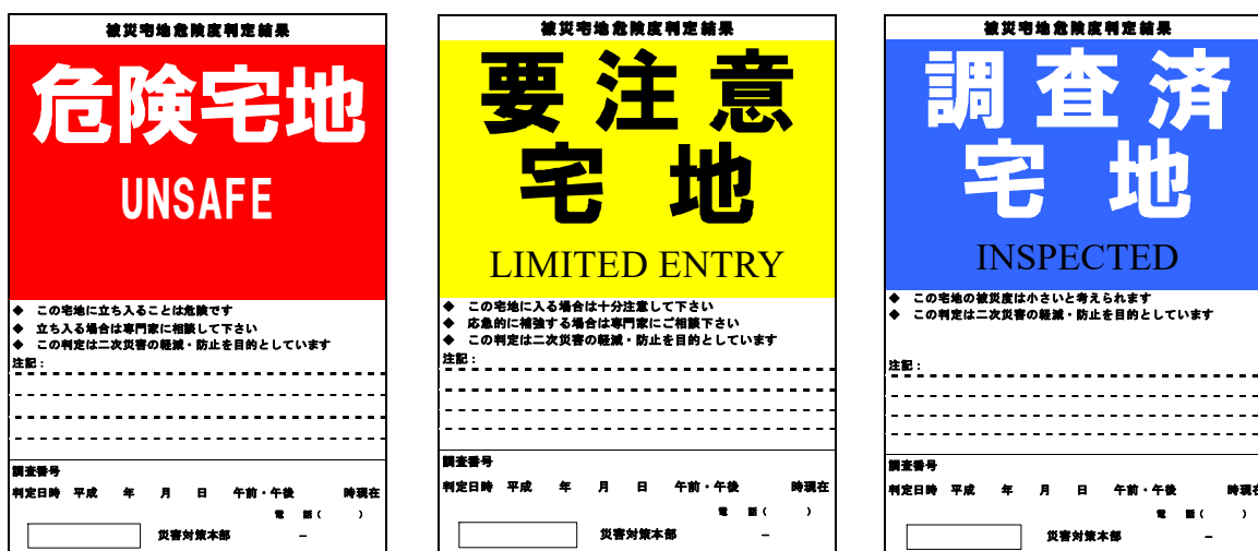
図 2.1 被災宅地危険度判定ステッカー
