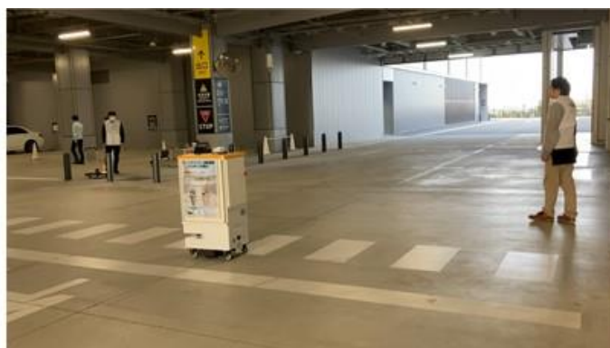
ロボットが横断歩道 (a) を横断中に、侵入物を検知しても一時停止せず走行する様子
