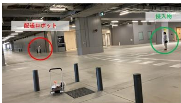
ロボットが横断歩道 (a) の手前で、検知エリア0に侵入物 (人) を検知して一時停止している様子
