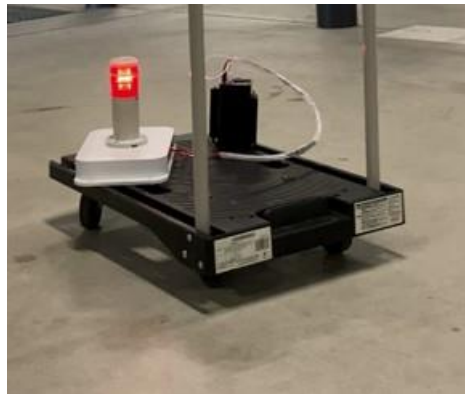
図表 4-1-3 侵入物検知状況可視化システムが侵入物を検知してパトランプが点灯する様子
