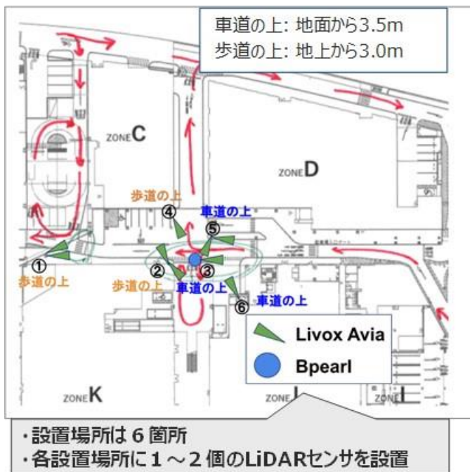
図表 4-1-6 LiDAR の設置状況
