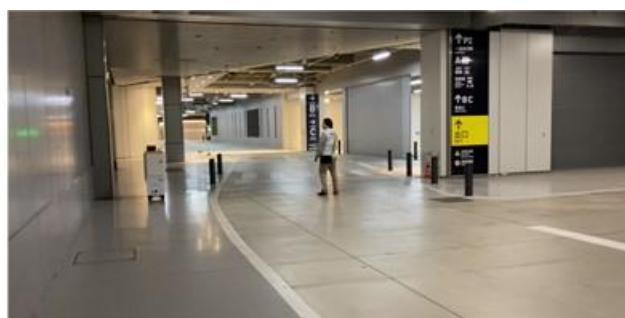
ロボットが横断歩道 (b) 手前で侵入物 (人) を検知して一時停止している様子
