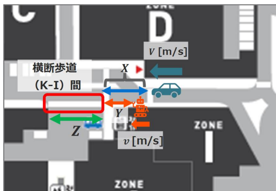
図表 4-1-35 横断歩道(K-I 間)横断を想定した机上検証パラメータ
