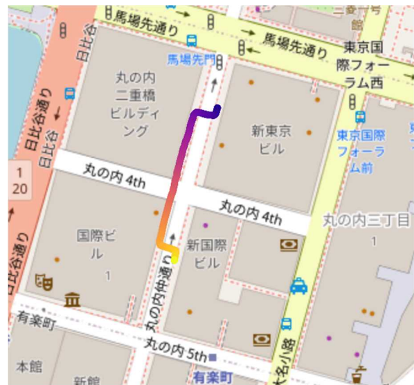
図5-19 自己位置推定結果から変換した緯度経度の軌跡
