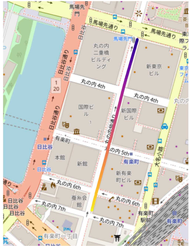
図5-17 自己位置推定結果から変換した緯度経度の軌跡
