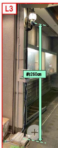
図 3.4.4 レーザーセンサーの設置状況（大手町通り北側一東）
