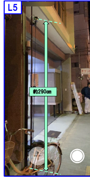
図 3. 4. 5 レーザーセンサーの設置状況（大手町通り北側一西）
