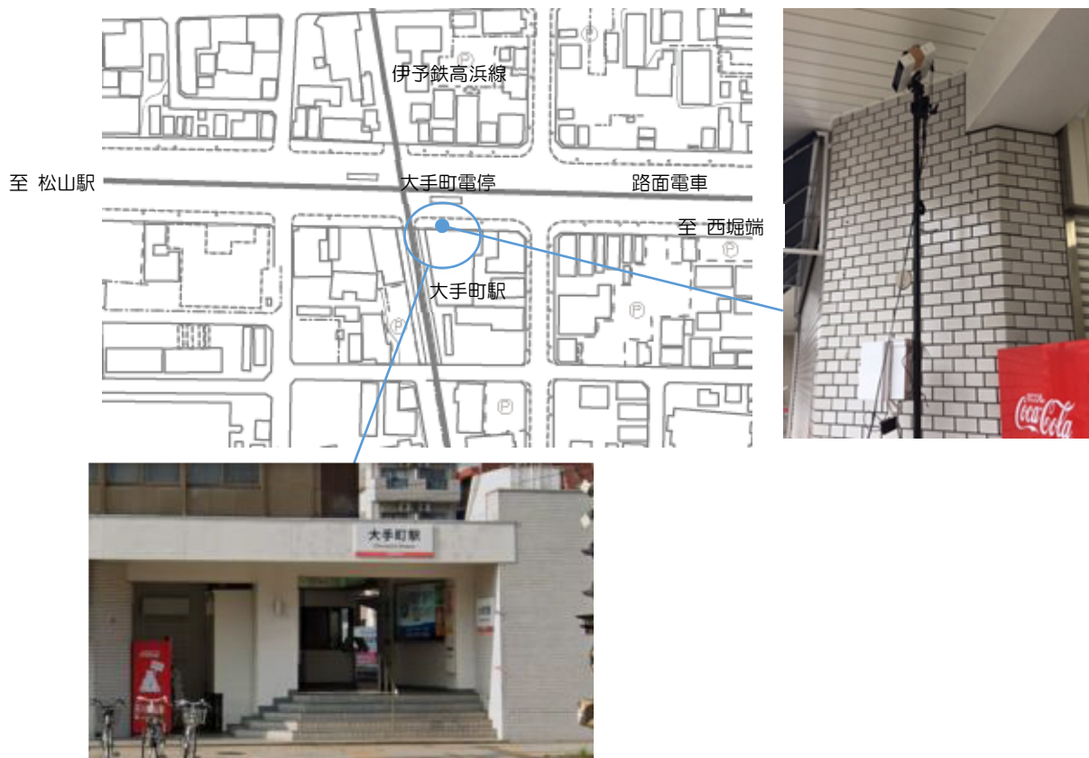
図 3.3.1 ステレオカメラ設置箇所・設置状況
