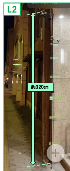
図 3.4.3 レーザーセンサーの設置状況（大手町通り南側）
