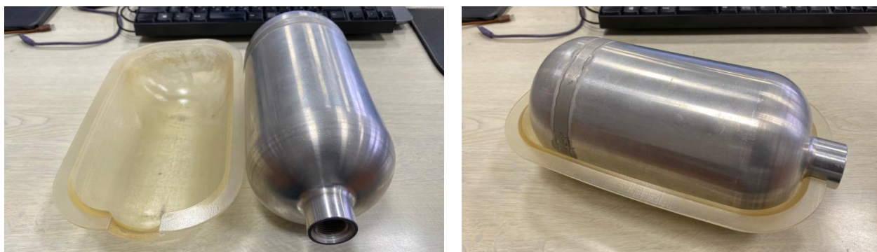
(参考写真) 水素タンクの強度向上に関わる金型の試作品（東光鉄工）
