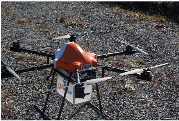
写真⑦ 宅配BOXがセットされた実機
