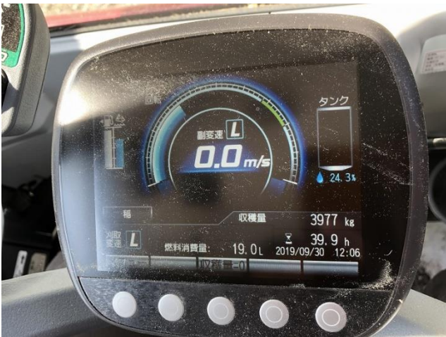
写真③ コンバイン内でのリアルタイム確認
