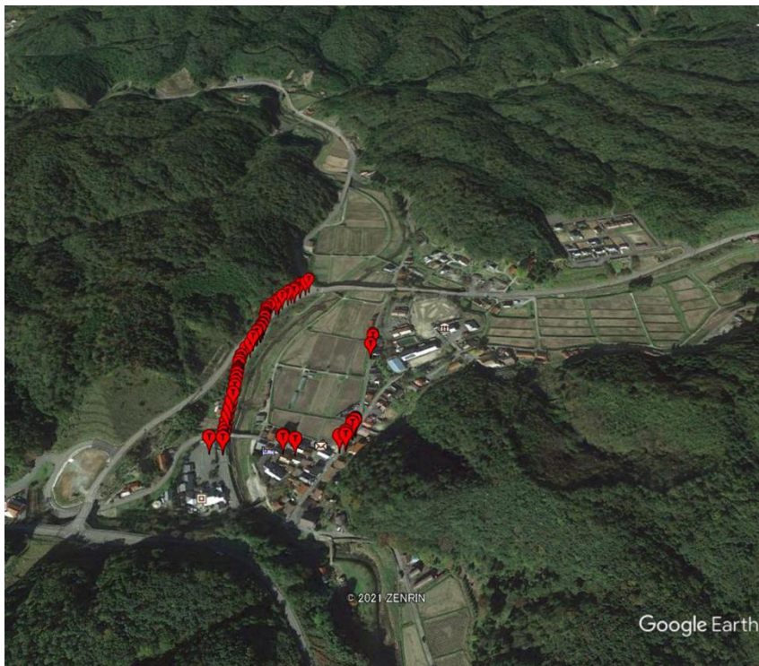
図 5-5:美都町美都温泉元湯館付近での実験結果1 微弱 LPWA 発信機での移動経路をグーグルアース上にプロット(赤マーク)
