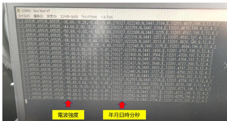
写真 5-8 LPWA 微弱発信機からの電波受信画面 10 秒間隔で受信できている
