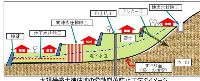
大規模盛土造成地の滑動崩落防止工法のイメージ
