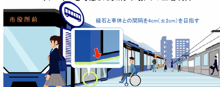
図 バス停での正着システム
