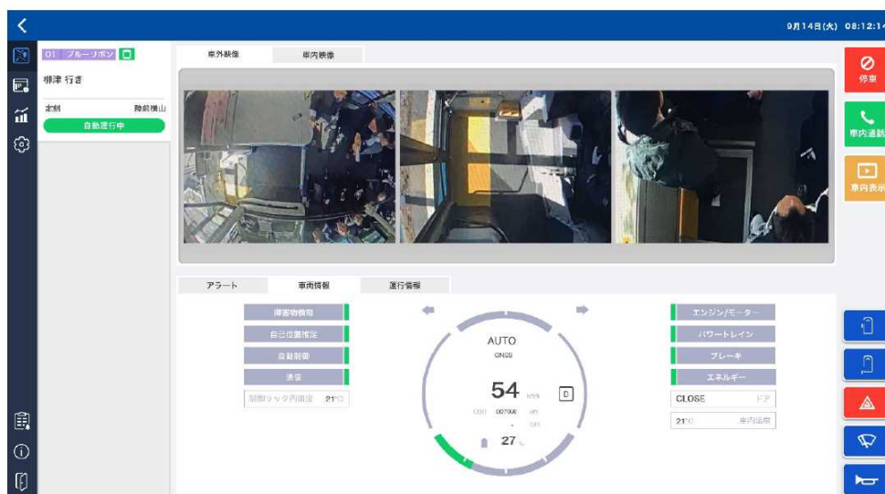
図 5: 遠隔監視システムのモニタ画像
