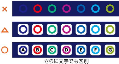
図-3.1.4 形の違いによる分かりやすさへの配慮 （伊藤（2012）より引用）
