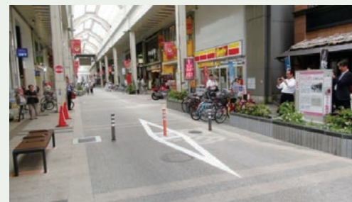
ライジングボラード（新潟県 新潟市） ・規制時間に合わせてボラードが昇降 ・許可車両はリモコンにより下降操作のみを行う 写真：第5回ストリートデザイン懇談会 小嶋委員資料
