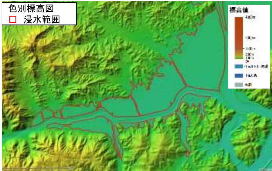
標高の低い平地が浸水している。
