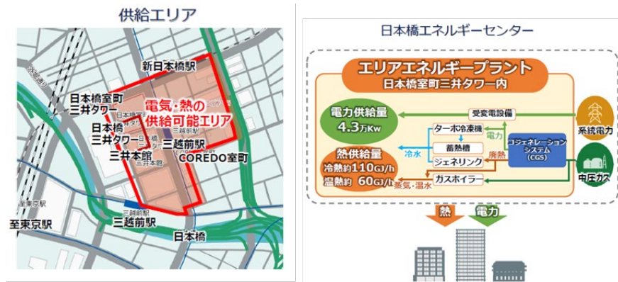
図 参考資料 1-26 「日本橋室町三井タワー」での防災関連の取組—電気・熱の供給可能エリア、日本橋エネルギーセンター
