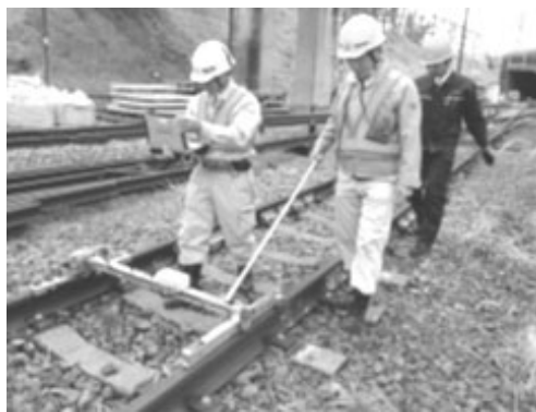
軌道変位計測の様子
