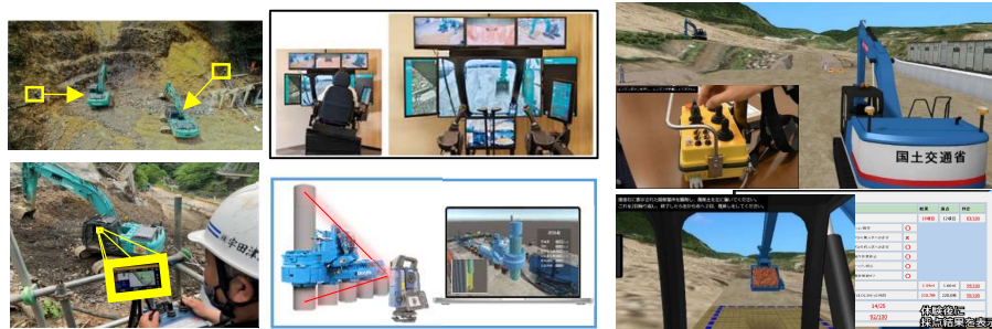
遠隔施工技術 長距離遠隔施工技術 遠隔施工技術(バーチャル)
