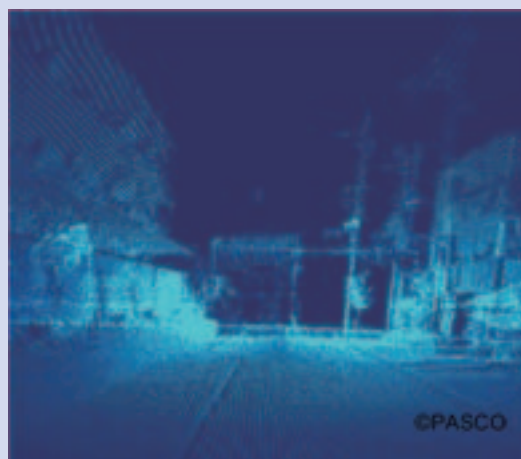
図3 MMSから照射されたレーザーによる位置情報
