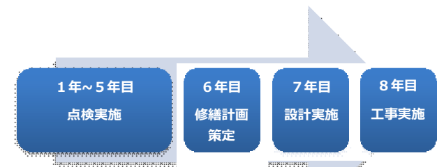
(2) 点検～工事サイクル（過去の事例）
