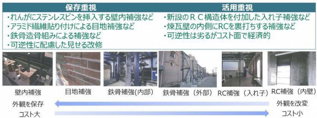
図表 53 煉瓦造建造物の補強各案
