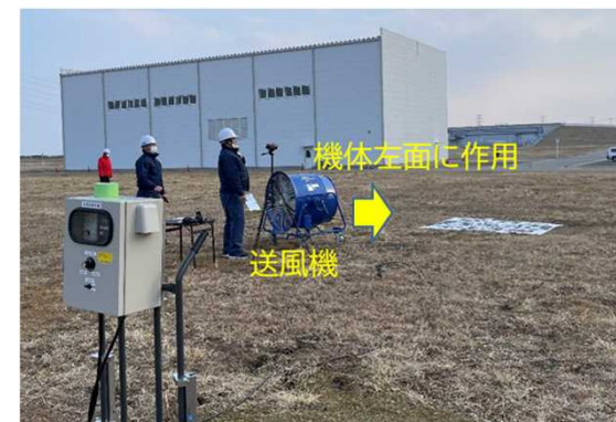
送風機による風発生(屋外)状況
