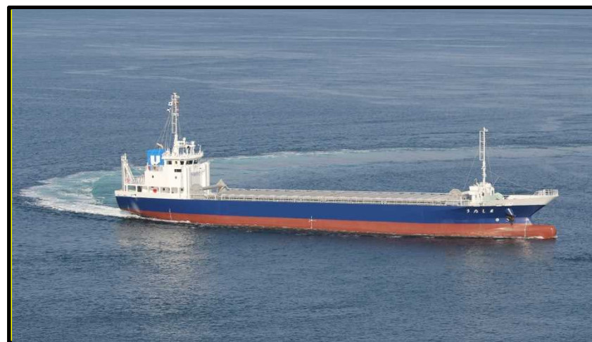
リチウムイオン電池搭載ハイブリッド貨物船 「うたしま」
