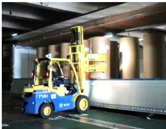
RORO船内でのバラ荷役の様子
