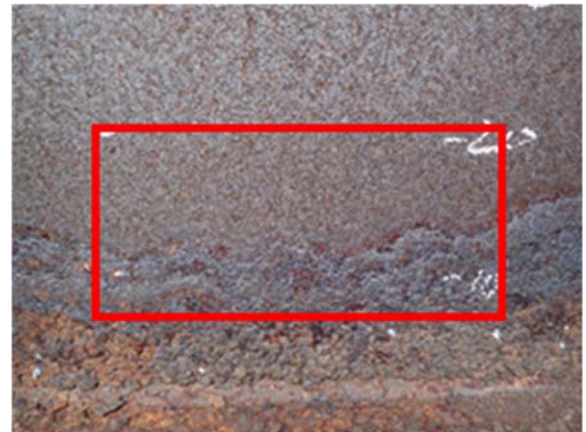
写真-3.2 I-4以上で技術者評点2以下, 画像解析評価評点4以上の試料のセロテープ試験実施部位
