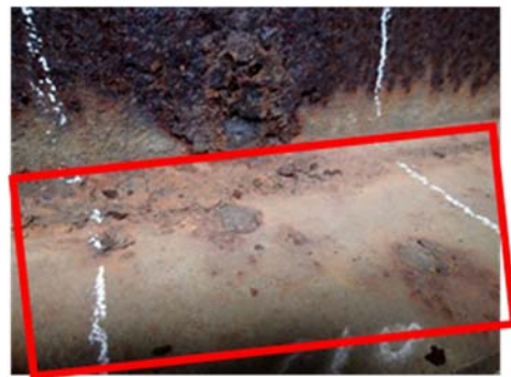
写真-3.1 技術者評価評点 2 以下で画像解析評価評点 4 以上の試料のセロテープ試験実施部位
