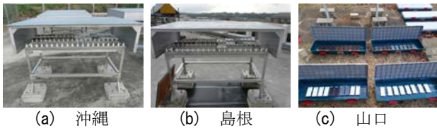
写真-4.1 曝露試験片設置状況
