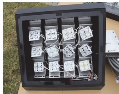
図4-2 12ユニット構成の試作プロビーム道路灯の外観
