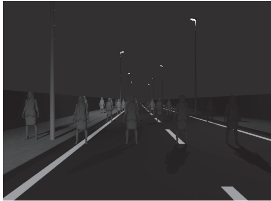
図 1-5 対称配光とプロビーム配光のときの道路上の歩行者の見え方 (シミュレーション)
