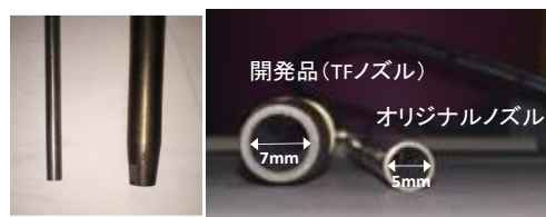
写真3 検討したノズルの外観
