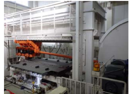
図3 輪荷重走行試験
