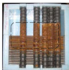
コンクリート打設前の鉄筋の配筋状況。 点線内領域が赤錆領域となる。
