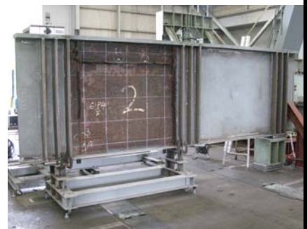
図8 せん断耐荷力の試験桁
