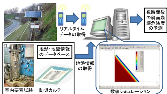
図2 寒冷地斜面用崩壊予知システム
