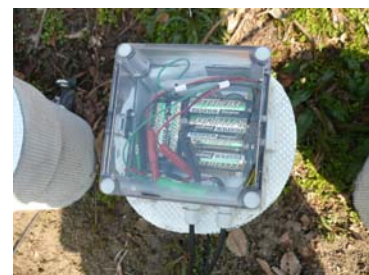
写真-3 センサーノード (MDA300 ノード : 3324)
