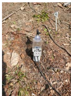
写真-2 テンシオメータ設置状況
