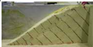
図-3 遠心実験によるすべりの再現
