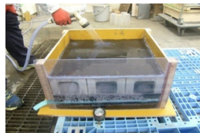
写真 2-4 排水能力確認試験
