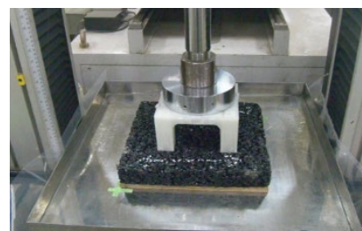
写真 2-3 塑性変形の試験状況
