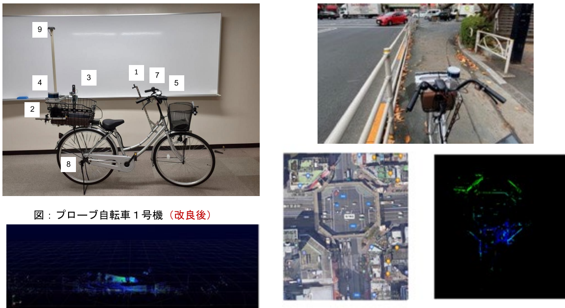
図2 改良したプローブ自転車の概要とLidarセンサーによる自転車視点の周辺自動車の状況
