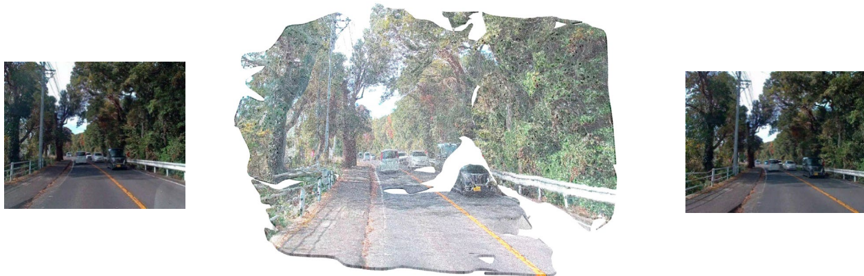
(c) SfMと3DセグメンテーションAIを用いた道路上物体の検出法
