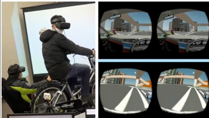
図-2.2 HMD全方向視野型協調型サイクルシミュレータ (文教大学)
