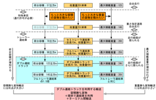
図 2-2-1 ダブル連結トラックの利用可能性がある車両と交通量の抽出方法案
