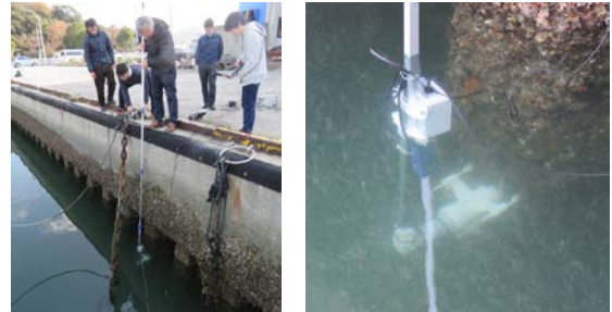
図1 水中部における貝殻付着物上からの測定
