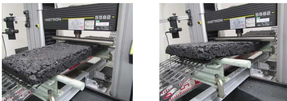
写真 c-3 曲げ試験の状況
