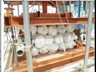
写真1 静的載荷試験装置
