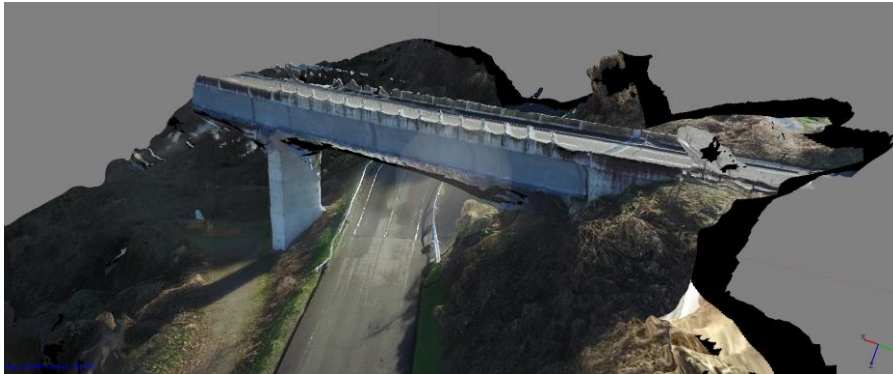
図 10 ドローン空撮動画を用いた道路の3次元データ化（金沢市角間町県道 27 号戸室大橋）
