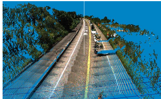
MMSによる石川県の国道計測データ
