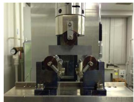
図22 3点曲げ疲労試験機
