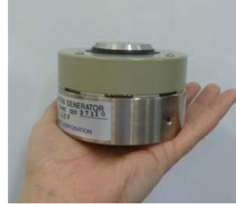
加振器を用いてsine波を与え、構造物の応答を計測する
