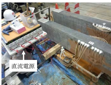
写真-2 電食試験 (鋼板供試体)
