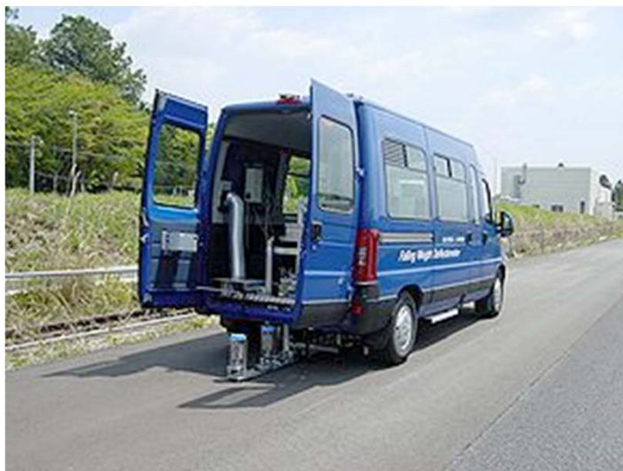
FWDによる舗装の支持力調査
