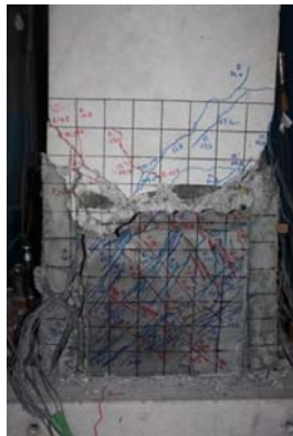
補修供試体の損傷状況
