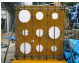
(a) 模擬水平ひび割れの設置
