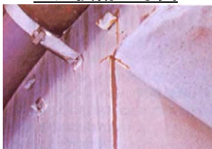
鋼製部材の疲労
