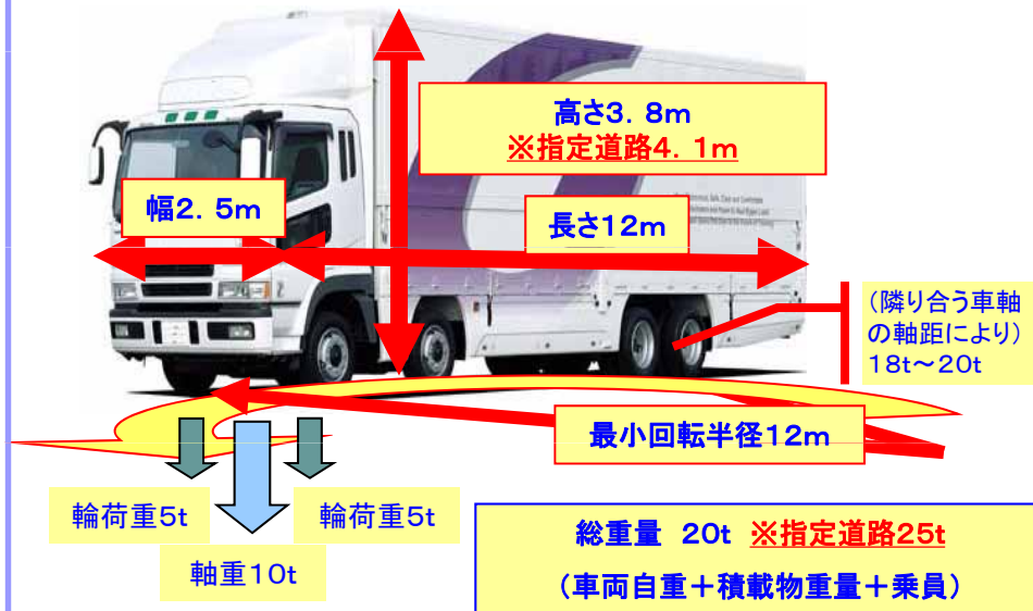
車両制限令第3条第1項に基づく車両の一般的制限値(上限値)
