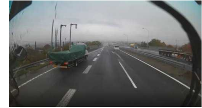
▲合流する大型車(バス)に対し、隊列トラックが本線側から接近したため、バスやトラック(一般車両)が合流できず停車。
