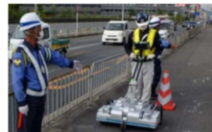
3Dレーダ探査による 地下埋設物の確認
