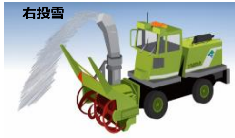
ブロー装置の投雪自動化 (右・左) シュート装置の投雪自動化 (右・左・前)
