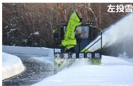
ブロー装置の投雪自動化 (右・左) シュート装置の投雪自動化 (右・左・前)
